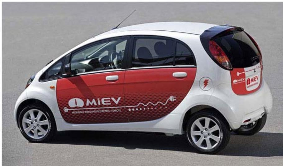
Se necesita menos de la tercera parte de la energía que consume un coche de gasolina similar para recorrer la misma distancia. Además, el i-MiEV recupera energía durante las retenciones, ya que el motor eléctrico actúa entonces como un generador que recarga la batería. También el sistema de propulsión tiene un consumo virtualmente nulo cuando el coche está detenido, aventajando incluso a los coches con motor de combustión dotados de start-stop, que gastan energía al volver a arrancarlo.
